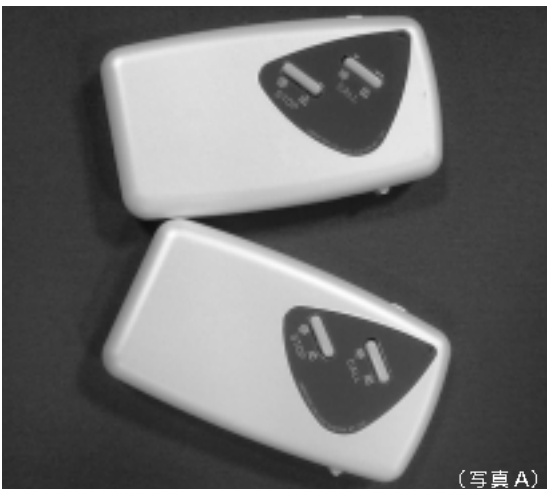
■「合図くん05」 使用周波数：429MHz帯 通信方式：特定小電力による双方向指向 電源：単4電池、各1ヶ 寸法：振動受信器 縦80×横44×幅14 (ミリ) 価格：1セット 34,650円 (税込み)
